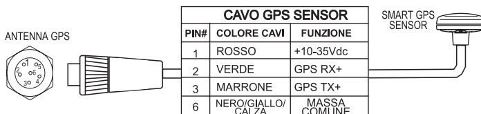
Fig. 2.5.1a - Connessioni GPS sulla Porta 2
