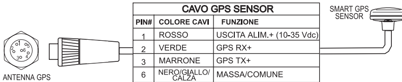
Fig. 2.4.1 - Connessioni GPS sulla Porta 3
